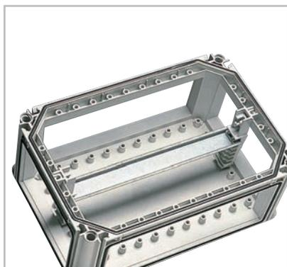
El soporte universal se monta sin necesidad de tornillería y permite ajustar en profundidad el carril o la placa de montaje. Este soporte se inserta simplemente a presión en la base.
